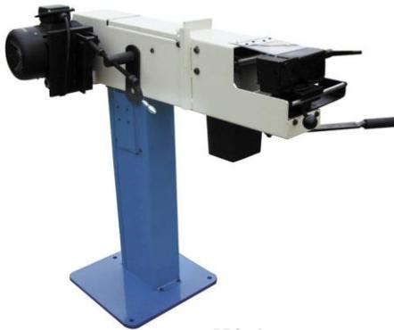
Bandschleifer für Rohr- und Profilen; für den
